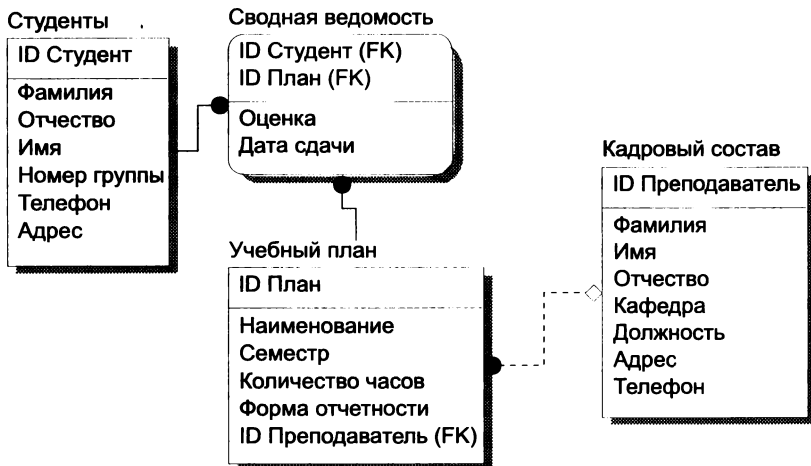
Рис. 6.8. Реляционная схема со связями
